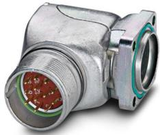
Gerätesteckverbinder Vorderwand, gewinkelt fest, Schraubverriegelung, M23, Polzahl: 16, Kontaktart: Stift, O-Ring axial, 4x Ø 3,2, geschirmt: ja, Flanschmaß: 26 mm x 26 mm, Polzahl: 16, Anschlussart: Crimpanschluss, Serie: RF
