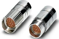
Kupplungssteckverbinder, gerade, Schraubverriegelung, M23, Polzahl: 16, Kontaktart: Stift, geschirmt: ja, Kabeldurchmesserbereich: 6 mm ... 10 mm, Polzahl: 16, Anschlussart: Crimpanschluss, Serie: RF, Alternativprodukt nach RoHS II ohne Ausnahme 6c (Pb < 0,1 %) Art.-Nr.: 1242818
