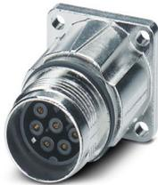
Gerätesteckverbinder Vorderwand, gerade, für Standard- und SPEEDCON-Verriegelung, M17, Polzahl: 5+3+PE, Kontaktart: Buchse, O-Ring axial, geschirmt: ja, Flanschmaß: 21,6 mm x 21,6 mm, Polzahl: 9, Anschlussart: Crimpanschluss, Serie: ST
