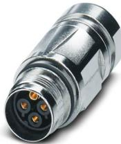
Kupplungssteckverbinder, gerade, für Standard- und SPEEDCON-Verriegelung, M17, Polzahl: 5+3+PE, Kontaktart: Buchse, geschirmt: ja, Schutzart: IP67, Kabeldurchmesserbereich: 8 mm ... 10 mm, Polzahl: 9, Anschlussart: Crimpanschluss, Serie: ST, dieser Artikel ist voraussichtlich ab 2025-Q3 nach RoHS II ohne Ausnahme 6c (Pb < 0,1 %) bleifrei, auf Anfrage ist eine bleifreie Alternative vorab möglich
