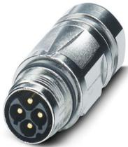
Kupplungssteckverbinder, gerade, für Standard- und SPEEDCON-Verriegelung, M17, Polzahl: 6+PE, Kontaktart: Stift, geschirmt: ja, Schutzart: IP67, Kabeldurchmesserbereich: 8 mm ... 10 mm, Polzahl: 7, Anschlussart: Crimpanschluss, Serie: ST, dieser Artikel ist voraussichtlich ab 2025-Q3 nach RoHS II ohne Ausnahme 6c (Pb < 0,1 %) bleifrei, auf Anfrage ist eine bleifreie Alternative vorab möglich
