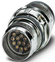
Gerätesteckverbinder Vorderwand, gerade, für Standard- und SPEEDCON-Verriegelung, M17, Polzahl: 17, Kontaktart: Buchse, O-Ring axial, geschirmt: ja, Polzahl: 17, Anschlussart: Crimpanschluss, Serie: ST, dieser Artikel ist voraussichtlich ab 2025-Q3 nach RoHS II ohne Ausnahme 6c (Pb < 0,1 %) bleifrei, auf Anfrage ist eine bleifreie Alternative vorab möglich
