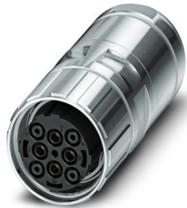
Kabelsteckverbinder, gerade lang, Schraubverriegelung, M40, Polzahl: 4+3+PE, Kontaktart: Buchse, geschirmt: ja, Schutzart: IP67, Kabeldurchmesserbereich: 14 mm ... 20,5 mm, Polzahl: 8, Anschlussart: Crimpanschluss, Serie: SM, dieser Artikel ist voraussichtlich ab 2026-Q3 nach RoHS II ohne Ausnahme 6c (Pb < 0,1 %) bleifrei, auf Anfrage ist eine bleifreie Alternative vorab möglich
