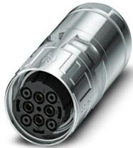
Kabelsteckverbinder, gerade, SPEEDCON, M40, Polzahl: 2+3+PE, Kontaktart: Buchse, geschirmt: ja, Schutzart: IP67, Kabeldurchmesserbereich: 14 mm ... 20,5 mm, Polzahl: 6, Anschlussart: Crimpanschluss, Serie: SM, dieser Artikel ist voraussichtlich ab 2025-Q3 nach RoHS II ohne Ausnahme 6c (Pb < 0,1 %) bleifrei, auf Anfrage ist eine bleifreie Alternative vorab möglich
