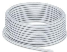
PROFINET-Powerkabel, 5x 2,5 mm<sup>2</sup>, flexibel (7-drähtig), Außenmantel: PVC, Außendurchmesser 11,8 mm, RAL 7001 (silbergrau), ölbeständig, Kabelring: 100 m
