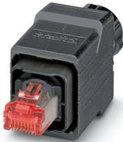
RJ45-Steckverbinder, Schutzart: IP65/IP67, Polzahl: 8, 1 GBit/s, CAT6, Material: Kunststoff, Anschlussart: Crimpanschluss, Kabelabgang: gerade, Farbe: schwarz, Ethernet
