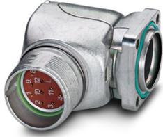
Gerätesteckverbinder Vorderwand, gewinkelt fest, Schraubverriegelung, M23, Polzahl: 17, Kontaktart: Buchse, O-Ring axial, 4x Ø 3,2, geschirmt: ja, Flanschmaß: 28 mm x 28 mm, Polzahl: 17, Anschlussart: Crimpanschluss, Serie: RF
