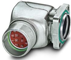
Gerätesteckverbinder Vorderwand, gewinkelt drehbar, Schraubverriegelung, M23, Polzahl: 17, Kontaktart: Stift, O-Ring axial, geschirmt: ja, Flanschmaß: 28 mm x 28 mm, Polzahl: 17, Anschlussart: Crimpanschluss, Serie: RF
