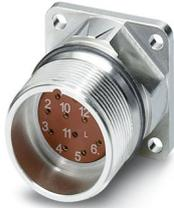
Gerätesteckverbinder Vorderwand, gerade, Schraubverriegelung, M23, Polzahl: 12, Kontaktart: Buchse, O-Ring axial, 4x Ø 2,7 mm, geschirmt: ja, Polzahl: 12, Anschlussart: Crimpanschluss, Serie: RF
