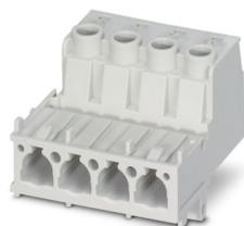
Kontakteinsatz, Artikelfamilie: VARIOCON, Bauform: VC2, Farbe: lichtgrau, Polzahl: 4, Aderquerschnitt min.: 0,5 mm<sup>2</sup>, Aderquerschnitt max.: 16 mm<sup>2</sup>, Bemessungsspannung: 690, Bemessungsstrom: 70 A, Anschlussart: Schraubanschluss, Steckverbinder dürfen nur leistungslos betätigt werden.
