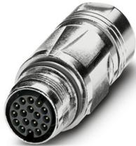
Kupplungssteckverbinder, gerade, für Standard- und SPEEDCON-Verriegelung, M17, Polzahl: 17, Kontaktart: Stift, geschirmt: ja, Schutzart: IP67, Kabeldurchmesserbereich: 5 mm ... 8 mm, Polzahl: 17, Anschlussart: Crimpanschluss, Serie: ST, dieser Artikel ist voraussichtlich ab 2025-Q4 nach RoHS II ohne Ausnahme 6c (Pb < 0,1 %) bleifrei, auf Anfrage ist eine bleifreie Alternative vorab möglich
