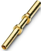
Crimpkontakt, Buchse, gedreht, Kontaktdurchmesser: 0,6 mm, Anschlussquerschnitt:  $0,06 \text{ mm}^2$  ..  $0,25 \text{ mm}^2$ , Material Kontakt: CuZn, Alternativprodukt nach RoHS II ohne Ausnahme 6c (Pb < 0,1 %) Art.-Nr.: 1242314
