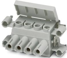
Kontakteinsatz, Artikelfamilie: VARIOCON, Bauform: VC2, Farbe: lichtgrau, Polzahl: 4, Aderquerschnitt min.: 0,5 mm<sup>2</sup>, Aderquerschnitt max.: 16 mm<sup>2</sup>, Bemessungsstrom: 70 A, Anschlussart: Schraubanschluss
