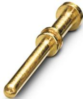
Crimpkontakt, Stift, gedreht, Kontaktdurchmesser: 2 mm, Anschlussquerschnitt: 0,75 mm<sup>2</sup> ... 1,5 mm<sup>2</sup>, Material Kontakt: CuZn, Alternativprodukt nach RoHS II ohne Ausnahme 6c (Pb < 0,1 %) Art.-Nr.: 1241953
