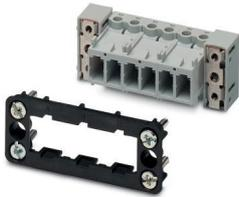
Kontakteinsatz-Set, Artikelfamilie: VARIOCON, Bauform: VC2, Polzahl: 6, Aderquerschnitt min.: 0,2 mm<sup>2</sup>, Aderquerschnitt max.: 4 mm<sup>2</sup>, Bemessungsspannung: 400, Bemessungsstrom: 20 A, Steckverbinder dürfen nur leistungslos betätigt werden.
