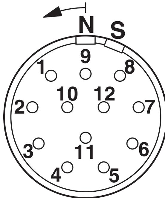
Kontaktkammernummerierung (Ansicht Steckseite) Buchse Standard
