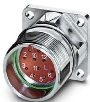
Gerätesteckverbinder Vorderwand, gerade, Schraubverriegelung, M23, Polzahl: 12, Kontaktart: Buchse, O-Ring axial, geschirmt: ja, Polzahl: 12, Anschlussart: Crimpanschluss, Serie: RF
