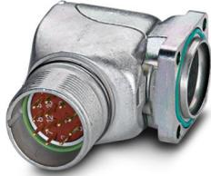
Gerätesteckverbinder Vorderwand, gewinkelt fest, Schraubverriegelung, M23, Polzahl: 12, Kontaktart: Stift, O-Ring axial, geschirmt: ja, Flanschmaß: 26 mm x 26 mm, Polzahl: 12, Anschlussart: Crimpanschluss, Serie: RF
