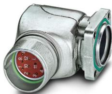
Gerätesteckverbinder Vorderwand, gewinkelt drehbar, Schraubverriegelung, M23, Polzahl: 12, Kontaktart: Stift, O-Ring axial, geschirmt: ja, Flanschmaß: 26 mm x 26 mm, Polzahl: 12, Anschlussart: Crimpanschluss, Serie: RF
