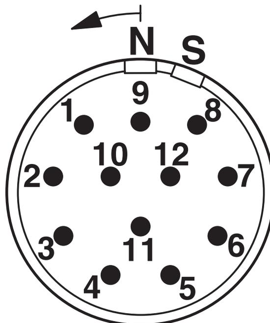
Kontaktkammernummerierung (Ansicht Steckseite) Stift Gegenlauf
