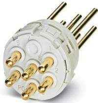
Kontakteinsatz, M23, Polzahl: 6, Kontaktart: Stift, Einlötanschluss, Serie: RC, TU, UC, dieser Artikel ist voraussichtlich ab 2027-Q1 nach RoHS II ohne Ausnahme 6c (Pb < 0,1 %) bleifrei, auf Anfrage ist eine bleifreie Alternative vorab möglich
