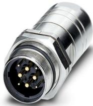
Durchführung Hinterwand, gerade kurz, Schraubverriegelung, M40, Polzahl: 4+3+PE, Kontaktart: Stift, O-Ring axial, Zentralbefestigung, geschirmt: ja, Kabeldurchmesserbereich: 17 mm ... 21 mm, Polzahl: 8, Anschlussart: Crimpanschluss, Serie: SM
