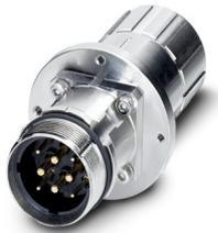
Wanddurchführung Stift/Buchse, gerade, M40, M40, Polzahl: 2+3+PE, Kontaktart: Buchse, O-Ring axial, 4xØM4, geschirmt: ja, Kabeldurchmesserbereich: 0 mm ... 0 mm, Polzahl: 6, Anschlussart: Crimpanschluss, Serie: SM
