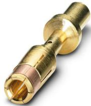
Crimpkontakt, Buchse, gedreht, Kontaktdurchmesser: 3,6 mm, Anschlussquerschnitt: 6 mm<sup>2</sup> ... 10 mm<sup>2</sup>, Material Kontakt: CuZn, Alternativprodukt nach RoHS II ohne Ausnahme 6c (Pb < 0,1 %) Art.-Nr.: 1241980
