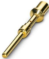
Crimpkontakt, Stift, gedreht, Kontaktdurchmesser: 2 mm, Anschlussquerschnitt: 4 mm<sup>2</sup> ... 4 mm<sup>2</sup>, Material Kontakt: CuZn, Alternativprodukt nach RoHS II ohne Ausnahme 6c (Pb < 0,1 %) Art.-Nr.: 1241969
