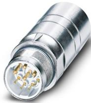
Kupplungssteckverbinder, gerade, Schraubverriegelung, M23, Polzahl: 4+3+PE, Kontaktart: Stift, geschirmt: ja, Schutzart: IP67, Kabeldurchmesserbereich: 7,5 mm ... 14 mm, Polzahl: 8, Anschlussart: Crimpanschluss, Serie: SF, dieser Artikel ist voraussichtlich ab 2027-Q1 nach RoHS II ohne Ausnahme 6c (Pb < 0,1 %) bleifrei, auf Anfrage ist eine bleifreie Alternative vorab möglich
