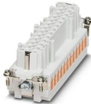
Kontakteinsatz, Polzahl: 24+PE, Baugröße: B24, Anzahl der Anschlüsse je Pol: 1, Buchse, QUICKON-Anschluss, 500 V, 16 A, 0,34 mm<sup>2</sup> ... 2,5 mm<sup>2</sup>
