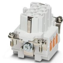
Kontakteinsatz, Polzahl: 6+PE, Baugröße: B6, Anzahl der Anschlüsse je Pol: 1, Buchse, QUICKON-Anschluss, 500 V, 16 A, 0,34 mm<sup>2</sup> ... 2,5 mm<sup>2</sup>
