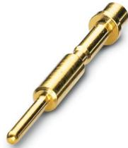
Crimpkontakt, Stift, gedreht, Kontaktdurchmesser: 1 mm, Anschlussquerschnitt: 0,25 mm<sup>2</sup> ... 1 mm<sup>2</sup>, Material Kontakt: CuZn, Alternativprodukt nach RoHS II ohne Ausnahme 6c (Pb < 0,1 %) Art.-Nr.: 1241921
