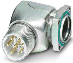
Gerätesteckverbinder Vorderwand, gewinkelt drehbar, für Standard- und SPEEDCON-Verriegelung, M23, Polzahl: 5+PE, Kontaktart: Stift, O-Ring axial, geschirmt: ja, Flanschmaß: 26 mm x 26 mm, Polzahl: 6, Anschlussart: Crimpanschluss, Serie: SF
