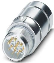
Kupplungssteckverbinder, gerade kurz, für Standard- und SPEEDCON-Verriegelung, M23, Polzahl: 5+PE, Kontaktart: Stift, geschirmt: ja, Schutzart: IP67, Kabeldurchmesserbereich: 7,5 mm ... 14 mm, Kompatibel zu Gegensteckern mit SPEEDCON- oder M23-Standard-Rändelmutter, Polzahl: 6, Anschlussart: Crimpanschluss, Serie: SF, dieser Artikel ist voraussichtlich ab 2027-Q1 nach RoHS II ohne Ausnahme 6c (Pb < 0,1 %) bleifrei, auf Anfrage ist eine bleifreie Alternative vorab möglich
