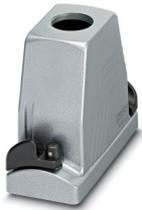
HEAVYCON ADVANCE Standard-Pulverbeschichtet, Tüllengehäuse B16, mit Bajonettverriegelung, Höhe 100 mm, mit Gewinde 1x M32, geradem Kabelabgang
