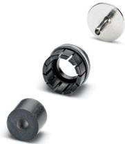
Kabelklemmkorb und Schirmadapter, geschirmt: ja, Litzenbündeldurchmesser: 4,1 mm, Kabeldurchmesserbereich: 5,5 mm ... 6,5 mm, Serie: NC, RC, dieser Artikel ist voraussichtlich ab 2027-Q1 nach RoHS II ohne Ausnahme 6c (Pb < 0,1 %) bleifrei, auf Anfrage ist eine bleifreie Alternative vorab möglich
