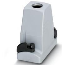
HEAVYCON ADVANCE EMV Tüllengehäuse B10, mit Bajonettverriegelung, Höhe 100 mm, mit Gewinde 1x M25, geradem Kabelabgang
