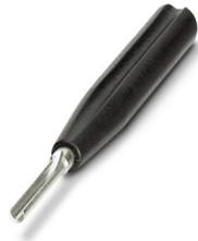
Einsetz- und Entriegelungswerkzeug für RC-Crimpkontakte Stift/Buchse, Durchmesser: 1 mm, Anschlussquerschnitt: 0,08 mm<sup>2</sup> ... 0,56 mm<sup>2</sup>
