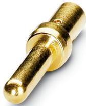
Crimpkontakt, Stift, gedreht, Kontaktdurchmesser: 2 mm, Anschlussquerschnitt: 0,5 mm<sup>2</sup> ... 0,75 mm<sup>2</sup>, Material Kontakt: CuZn, Alternativprodukt nach RoHS II ohne Ausnahme 6c (Pb < 0,1 %) Art.-Nr.: 1241632
