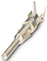
Crimpkontakt, Stift, gerollt, Kontakt durchmesser: 1 mm, Anschlussquerschnitt: 0,22 mm<sup>2</sup> ... 0,56 mm<sup>2</sup>, Material Kontakt: Cu-Legierung, Artikel ist bleifrei nach RoHS II ohne Ausnahme 6c (Pb < 0,1 %)
