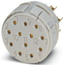
Kontakteinsatz, M23, Polzahl: 16+3, Kontaktart: Buchse, Lötkelch, Serie: NC, RC, RM, TU, UC, dieser Artikel ist voraussichtlich ab 2025-Q3 nach RoHS II ohne Ausnahme 6c (Pb < 0,1 %) bleifrei, auf Anfrage ist eine bleifreie Alternative vorab möglich
