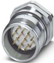
M23, Gerätesteckverbinder Vorderwand, Serie: RC, gerade, geschirmt: ja, Schraubverriegelung, Polzahl: 12, Drehsinn: Standard, Kontaktart: Stift, Lötkehl, O-Ring axial, Wandstärke min.: 0,8 mm, Wandstärke max.: 6,5 mm, Kodierung: N, dieser Artikel ist voraussichtlich ab 2026-Q1 nach RoHS II ohne Ausnahme 6c (Pb < 0,1 %) bleifrei, auf Anfrage ist eine bleifreie Alternative vorab möglich
