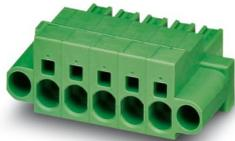
Leiterplattenstecker, Nennquerschnitt: 6 mm<sup>2</sup>, Farbe: grün, Nennstrom: 32 A, Bemessungsspannung (III/2): 1000 V, Kontaktoberfläche: Sn, Kontaktart: Buchse, Anzahl der Reihen: 1, Polzahl: 3, Artikelfamilie: SPC 5/..-STF, Rastermaß: 7,62 mm, Anschlussart: Push-in-Federanschluss, Anschlussrichtung Leiter/Platine: 0 °, Rasthaken: - ohne Rasthaken, Stecksystem: COMBICON PC 5, Verriegelung: Schraubverriegelung, Befestigungsart: Schraubflansch, Verpackungsart: verpackt im Karton
