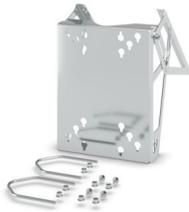
Grundhalter für Pico-Off-Grid-System, Befestigung für Mast-Ø 48 mm ... 108 mm, kompatibel mit POS-HP-Gehäusegrößen 204 x 251 mm bis 308 x 352 mm und POS-PV-Panel 22, Material: Edelstahl
