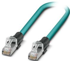
Patch-Kabel, CAT6A, 4-paarig, geschirmt, beidseitig konfektioniert mit umspritzten RJ45-Steckverbindern, Schutzart IP20, Material Außenmantel: PUR, Länge: 20 m
