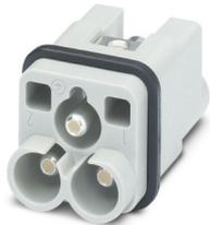
Kontakteinsatz, Polzahl: 2+PE, Baugröße: D7, Leistungskontakte: 2, Stift, Axialschraubanschluss, 400 V, 40 A, 4 mm<sup>2</sup> ... 10 mm<sup>2</sup>, Anwendung: Leistung
