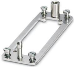
Andockrahmen für Einschübe, für Kontakteinsätze der Bauform B24, mit 4 Flachkopfschrauben M5, Einschubausgleich x/y-Achse  $\pm 1,5$  mm
