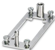
Andockrahmen für Einschübe, für Kontakteinsätze der Bauform B16, mit 4 Flachkopfschrauben M5, Einschubausgleich x/y-Achse  $\pm 1,5$  mm
