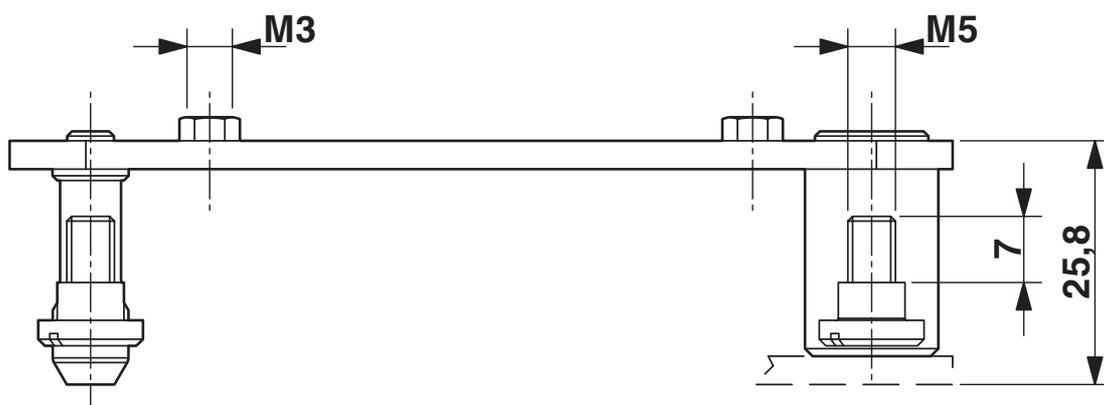
max. Abstandsmaß der beiden Andockrahmen ( bei Standardkontakten 25,8 mm; bei LWL-Kontakten 27 mm; bei Pneumatikkontakten 26,5 mm )
