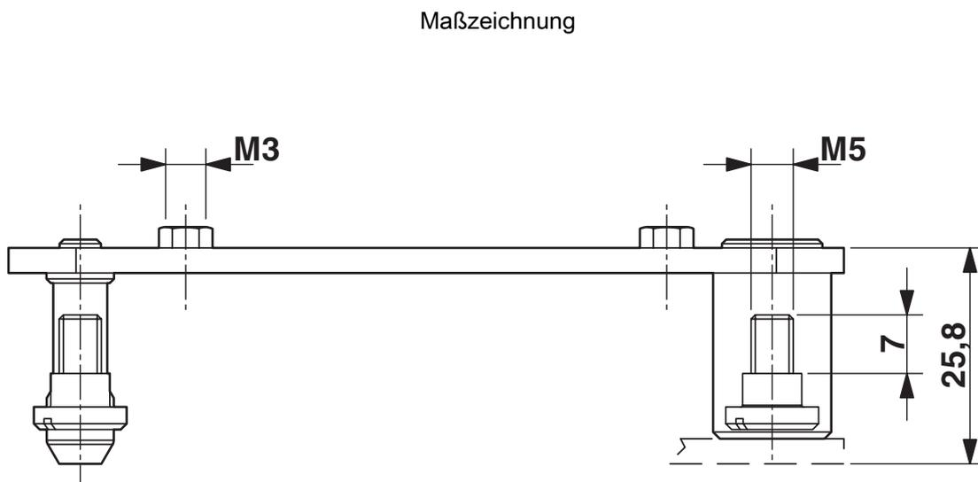
max. Abstandsmaß der beiden Andockrahmen ( bei Standardkontakten 25,8 mm; bei LWL-Kontakten 27 mm; bei Pneumatikkontakten 26,5 mm )
