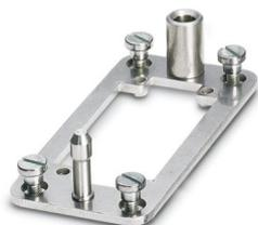
Andockrahmen für Einschübe, für Kontakteinsätze der Bauform B10, mit 4 Flachkopfschrauben M5, Einschubausgleich x/y-Achse  $\pm 1,5$  mm
