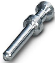
Crimpkontakt, Serie: HC-M-06; HC-M-HV; HC-M-08; HC-A; HC-BB; HC-B; HC-HV, Stift, gedreht, Kontaktdurchmesser: 2,5 mm, Bemessungsstrom: 16 A, Material Kontakt: CuNi
