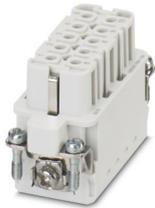
Kontakteinsatz, Polzahl: 10+PE, Baugröße: D15, Anzahl der Anschlüsse je Pol: 1, Buchse, Push-in-Anschluss, 250 V, 16 A, 0,14 mm<sup>2</sup> ... 2,5 mm<sup>2</sup>
